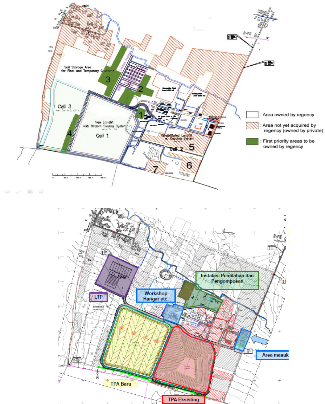
Gambar 2.5. SITE PLAN RENCANA PENGEMBANGAN TPA DENGAN SISTEM SANITARY LANDFILL
